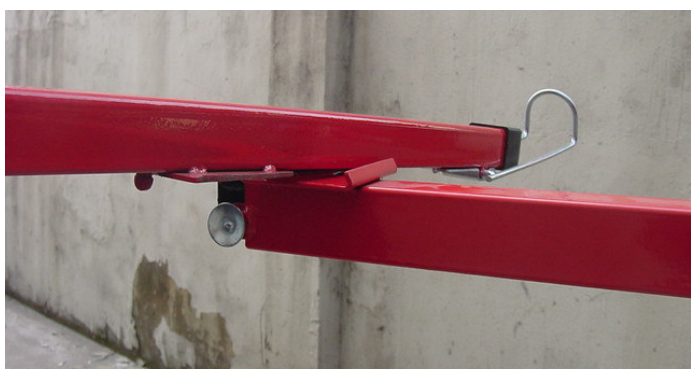
Obr. 9. Umístěte kónické desky opěrných ramen do kónických otvorů na naklápacím rameni. Zajišťovací kolík na zadní straně opěrného ramene zajistí stabilní polohu.
