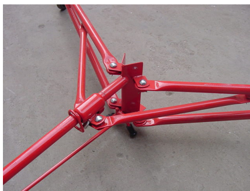
Obr. 4. Ujistěte se, že je úhel hlavního stojanu ve stejném úhlu jako úhel na základně.
