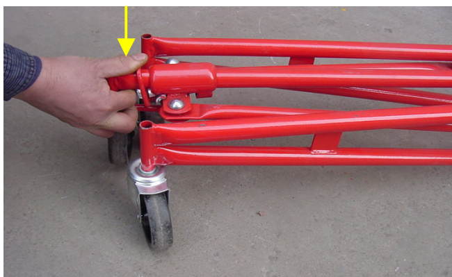
Obr. 1. Začněte nastavením 3-ramenné základny: Zatlačte směrem dolů na kotvící kroužek a roztáhněte ramena základny dokud neuslyšíte zacvaknutí - v pracovní poloze (otvory ve spodní straně posuvné trubky).
