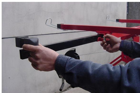
Obr. 10. Pro prodloužení naklápacího ramene vytáhněte zajišťovací kolík pravou rukou a levou vysuňte rameno do požadované délky. Zajišťovací kolík lze zasunout ve více polohách. UJISTĚTE SE, že jsou zajišťovací kolíky řádně zasunuty před naložením nákladu. Při uskladnění nebo přepravě musí být prodloužitelné části naklápacího ramene zasunuty uvnitř ramene a zajištěny proti vysunutí.
