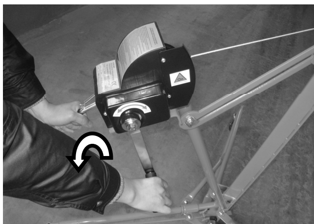
Obr. 6. Lehce otáčejte pákou navijáku směrem dozadu (proti vám), dokud nezapadne zajišťovací podložka do drážky kluzné tyče.
